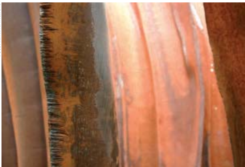
Figuur 2 - Cortenstaal, een weervaste staalsoort
